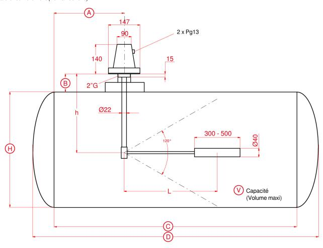
Les cotes A, B, C, D et H ainsi que la capacité V du réservoir sont à fournir par le client. Si le réservoir a une forme rectangulaire, le client doit également préciser sa largeur.
